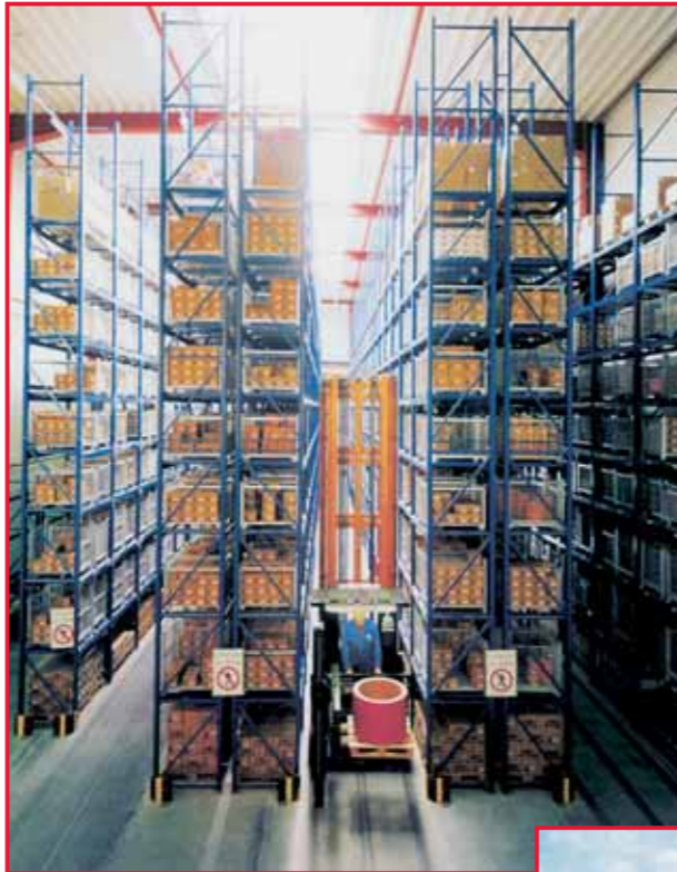
Das Mitte 1996 errichtete zentral-computergesteuerte Hochregallager
