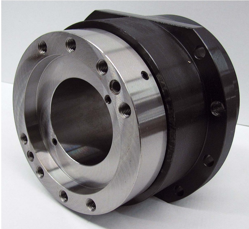
Lagerung einer angetriebenen KGT-Mutter mit Präzisionsflanschlagereinheit der Serie BNBUS mit gekröpftem Adapter und integrierter Drehdurchführung zur Schmierung der Mutter
